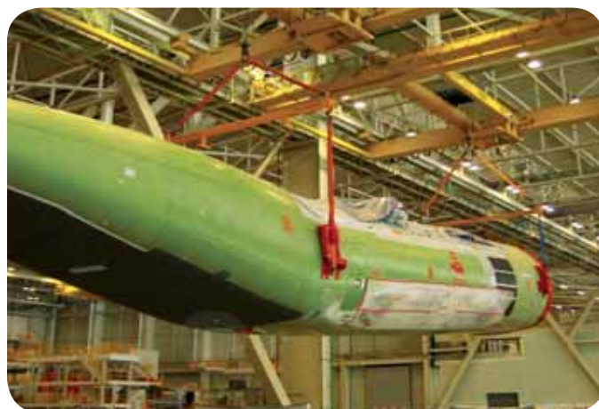
FLERPUNKTS UNDERHENGTE KRANER i tandem
