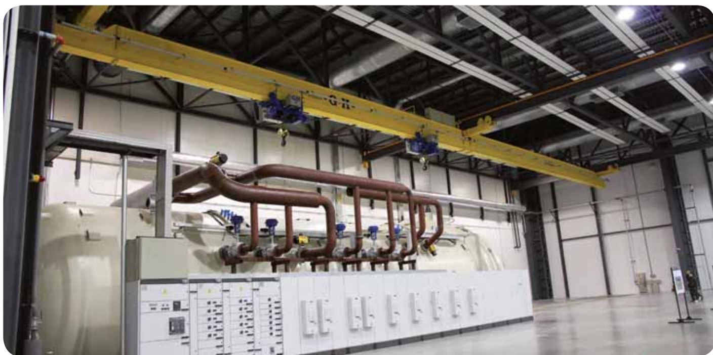
FLERPUNKTS UNDERHENGende KRAN MED DOBBEL kjørebjelke. KAPASITET OPPTIL 20+20 t.
