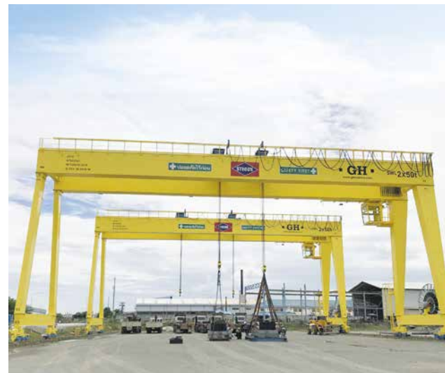
Grúas móviles de doble viga de 100 t (arriba) y 22 t (abajo), en sendos proyectos de STECON en Tailandia.
